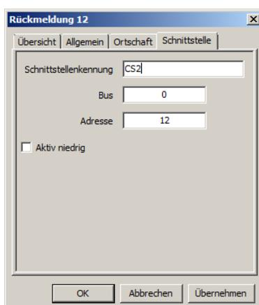
Bei Verwendung einer CS2 können Sie den Bus bei 0 belassen. Im Feld Adresse geben Sie die Nummer der Rückmelder aus dem Layout der CS2 ein.
