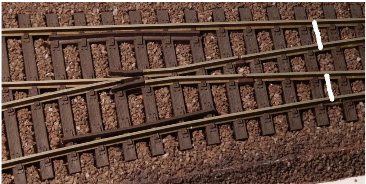
Abb. 3: ältere Tillig Elite Weiche mit nachträglicher Isolierung rechts vom Herzstück und hier nicht sichtbaren Strombrücken (weiß dargestellt) zwischen den Außenschienen
