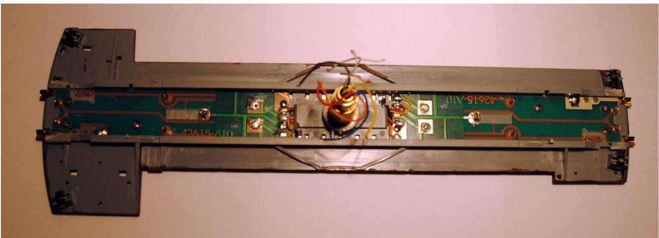
Abb 3: Die Bühnenelektrik ist bereits von Unnötigem befreit
