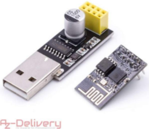
Der ESP8266-01 hat durch seinen WLAN 802.11 b/g/n Standard eine große Reichweite und ist universell einsetzbar. Das Modul unterstützt 3 Betriebsmodi: WLAN Router (AP), WLAN Client (STA) sowie beides gleichzeitig (AP + STA)! Der leistungsstarke 80MHz Prozessor und 1MB Speicher lassen den ESP8266-01 für viele Anwendungen einsetzen. Begrenzt ist er im Gegensatz zum großen Bruder (ESP8266-12E) durch 2 GPIO-Pins.
