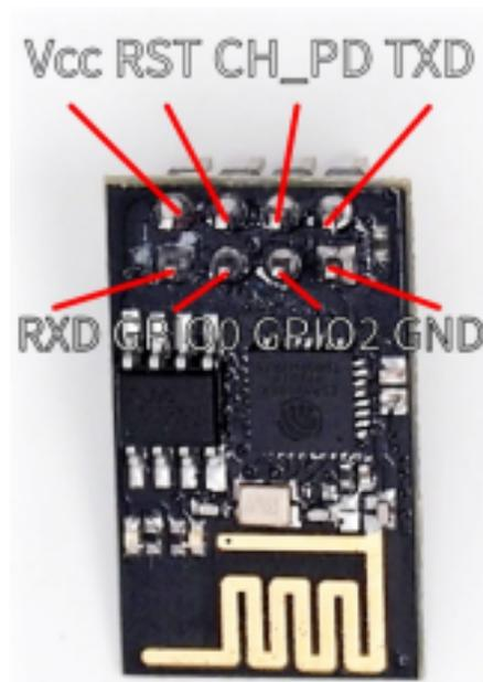
GPIO0 muss während des Bootens auf Masse liegen, damit der Chip in den Programmiermodus geht.
